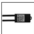
S.2407 ALIMENTATION ELECTRONIQUE NON GRADABLE 14,4W 230Vac/24Vdc IP67 Entrée: 230V Courant alternatif Sortie: 24V Courant continu. Le nombre maximum d'appareils dépend de la somme des puissances unitaires de l'appareil. IP67 CLASSE II SELV Dimensions: 79 x 38 x 25 mm L'UTILISATION DU DÉCHARGEUR À SURTENSION S.2499 EST RECOMMANDÉE POUR CHAQUE BALLAST ÉLECTRONIQUE QUI DOIT ÊTRE INSTALLÉ À UNE DISTANCE MAXIMALE DE 10m DE CELUI-CI.
