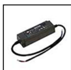
S.2405 ALIMENTATION ELECTRONIQUE NON GRADABLE 60W 230Vac/24Vdc IP67 Entrée: 230V Courant alternatif Sortie: 24V Courant continu. Le nombre maximum d'appareils dépend de la somme des puissances unitaires de l'appareil. CLASSE II SELV Dimensions: 150 x 53 x 21 mm L'UTILISATION DU DÉCHARGEUR À SURTENSION S.2499 EST RECOMMANDÉE POUR CHAQUE BALLAST ÉLECTRONIQUE QUI DOIT ÊTRE INSTALLÉ À UNE DISTANCE MAXIMALE DE 10m DE CELUI-CI.
