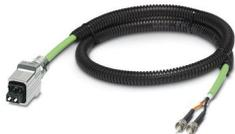
Câble en fibre optique équipé, câble PROFINET type B, fibre PCF 200/230  $\mu\text{m}$ , boîtier métallique Push-Pull SC-RJ/IP67 sur BFOC(ST)/IP20, gaine extérieure en PVC, exempt d'halogène, résistant à l'ozone et aux UV, dans une gaine de protection, pour pose fixe en intérieur, longueur : 10 m
