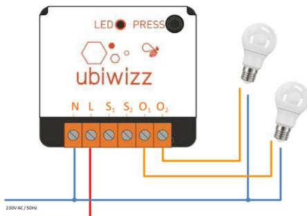
Câblage avec un interrupteur sans fil
