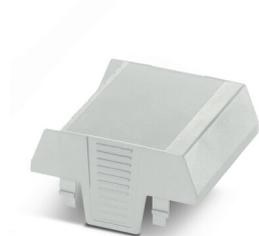
Boîtier électronique sur rail DIN, Partie supérieure du boîtier, design haut, ouverture de raccordement d'un côté, Ouverture de raccordement unilatérale, largeur: 70,1 mm, hauteur: 75 mm, profondeur: 36,95 mm, coloris: gris clair (7035)
