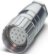
M23, Connecteurs à câble, série: RC, droit, blindé: non, Verrouillage à vis, Nombre de pôles: 7, Sens de rotation: standard, type de contact: Connecteur femelle, Cône de soudage, plage de diamètre de câble: 8 mm ... 12 mm, détrompage: N, Produit de remplacement selon RoHS II sans exception 6c (Pb < 0,1 %) référence : 1240515
