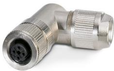
Connecteur de données, Ethernet CAT5 (100 Mbit/s), 4-pôles, blindé, connecteur femelle coudé M12, détrompage: D, Raccordement autodénudant, matériau de la molette: Laiton, nickelé, diamètre extérieur du câble 4 mm ... 8 mm
