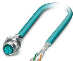
Connecteur d'appareil face arrière, Ethernet CAT5 (100 Mbit/s), Ethernet CAT5 (100 Mbit/s), 4-pôles, bleu lagon RAL 5021, connecteur femelle, droit, M12-SPEEDCONNEC, détrompage: D, sur extrémité libre, Montage face arrière, M16 x 1,5, Ligne de bus, 0,14 mm<sup>2</sup>, Produit de remplacement selon RoHS II sans exception 6c (Pb < 0,1 %) référence : 1239048
