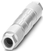
Prolongateur de câble, Ethernet, CAT5 (100 MBit/s), 4 pôles, exempt d'halogène, blindé, raccordement autodénudant, matière du boîtier : zinc moulé, nickelé, diamètre extérieur du câble de 5 mm à 9,7 mm 9,7 mm
