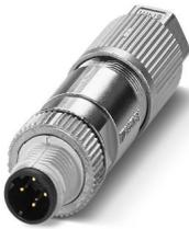
Connecteur de données, Ethernet CAT5 (100 Mbit/s), 4-pôles, exempt d'halogène, blindé, connecteur mâle droit M12, détrompage: D, Raccordement autodénudant, matériau de la molette: Zinc moulé sous pression, nickelé, diamètre extérieur du câble 5 mm ... 9,7 mm
