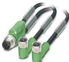
Câble pour capteurs/actionneurs, 3-pôles, PUR exempt d'halogène, gris-noir RAL 7021, connecteur mâle droit M12, détrompage: A, sur Connecteur femelle coudé M8, longueur de câble: 0,6 m
