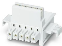
Connecteurs sur profilé, coloris: gris clair, intensité nominale: 8 A (contacts parallèles), tension de référence (III/2): 125 V, surface des contacts: Or, nombre de pôles: 5, pas: 3,81 mm, montage: Montage sur profilé, verrouillage: sans, type de fixation: sans, type de conditionnement: emballé dans un carton, Article avec contacts dorés, connecteur de bus pour le raccordement de boîtiers électroniques, 5 contacts parallèles
