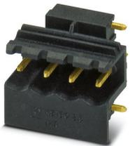
Embase de circuit imprimé, coloris: noir, surface des contacts: Or, type de contact: Mâle, nombre de pôles: 4, gamme d'articles: MSTBO 2,5/..-G1R THR Au, pas: 5 mm, montage: Soudage THR, plan des broches: Brochage linéaire, longueur de broche [P]: 2,5 mm, nombre de picots par potentiel: 1, système débrochable: COMBICON MSTB 2,5, type de conditionnement: Sangle en largeur de 44 mm, Article avec sortie de broche latérale droite
