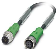
Câble pour capteurs/actionneurs, 5-pôles exempt d'halogène, connecteur mâle droit M12, détrompage: A, sur Connecteur femelle droit M12, détrompage: A, longueur de câble: 8,6 m, Molette inox
