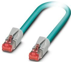
Câble de réseau, indice de protection: IP20, longueur de câble: 0,13 m, nombre de pôles: 8, 1 Gbit/s, CAT5, sortie du câble: droit, Ethernet
