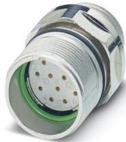
M23, Embases paroi avant, série: CA, droit, blindé: oui, Pour verrouillage standard et SPEEDCON, Nombre de pôles: 16, Sens de rotation: standard, type de contact: Connecteur femelle, Raccordement soudé, Joint axial, Fixation centrale M20 x 1,5, à positionner via un écrou de sécurité, détrompage: N
