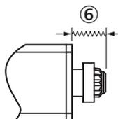
⑥ Plage de déplacement du capuchon à suspension (jusqu'à 5 mm de compression à l'état non monté)
