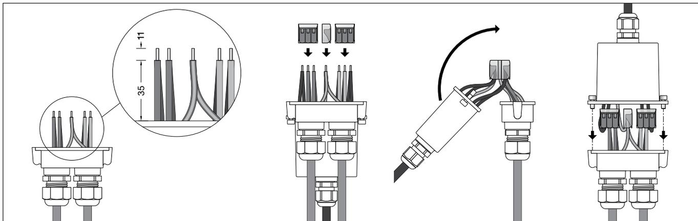
Pollerleuchterleuchtenrohr über den Aufschraubsockel führen und ausrichten. Dabei ist darauf zu achten, dass die Anschlussdose in das Standrohr eingeführt wird und die Verbindungsleitung zum Leuchtengehäuse nicht zwischen Anschlussdose und Standrohr eingeklemmt wird. Gegebenenfalls die Anschlussleitung stramm halten, um ein Einklemmen zu vermeiden. Schrauben gleichmäßig fest anziehen.
