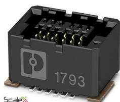
Connecteur femelle SMD, intensité nominale: 1,7 A, Tension d'essai: 500 V AC, nombre de pôles: 52, pas: 0,8 mm, coloris: noir, surface des contacts: Or, type de contact: Connecteur femelle, montage: Sertissage SMD
