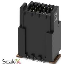
Connecteur mâle SMD, intensité nominale: 1,7 A, Tension d'essai: 500 V AC, nombre de pôles: 52, pas: 0,8 mm, coloris: noir, surface des contacts: Or, type de contact: Mâle, montage: Sertissage SMD
