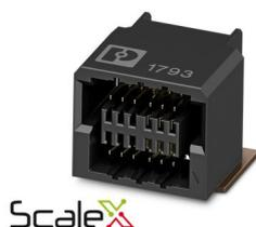
Connecteur femelle SMD, intensité nominale: 1,7 A, Tension d'essai: 500 V AC, nombre de pôles: 52, pas: 0,8 mm, coloris: noir, surface des contacts: Or, type de contact: Connecteur femelle, montage: Sertissage SMD
