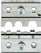
Matrice pour automate à sertir CF 500, pour cosse tubulaires 4 ... 10 mm<sup>2</sup>, **4 mm<sup>2</sup>**: Ø extérieur 5 mm, Ø intérieur 3 mm, **6 mm<sup>2</sup>** : Ø extérieur 6,5 mm, Ø intérieur 3,8 mm, **10 mm<sup>2</sup>** : Ø extérieur 6 mm, Ø intérieur 4,5 mm
