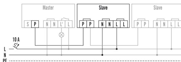
Raccordement maître/esclave. Un appareil maître peut être raccordé à 10 appareils esclaves au maximum.
