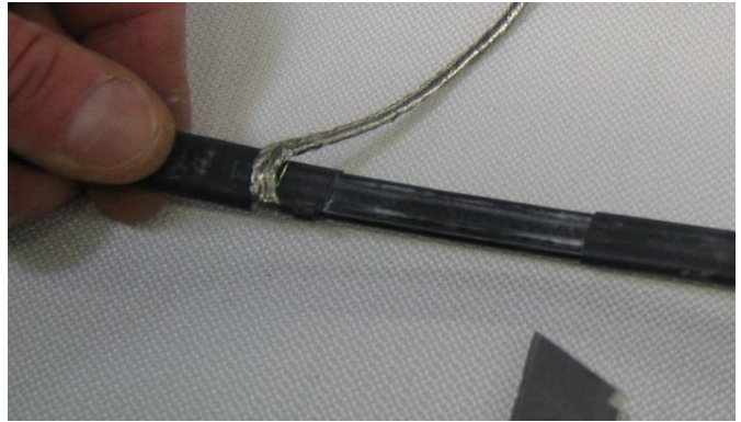
7) Couper et dégager la matrice autorégulante sur 10mm
