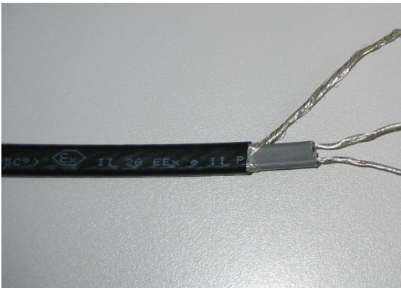
8) Dénuder les conducteurs en cuivre
