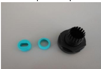
8) Raccorder la tresse torsadée sur le bornier et chaque brin sur chacun des 2 borniers restants Refaire la même opération de l'autre côté Faire glisser le corps sur le presse-étoupe et visser
