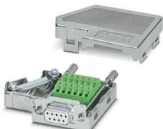
Connecteur mâle D-SUB , à 9 pôles, femelle, deux arrivées de câble inférieures à 35°, système de bus : MODBUS, MODBUS-PLUS, BITBUS, ARCNET, MULT/MININET (B&R), SYSTEM 2003 (B&R), P-NET, brochage : 1, 2, 3, 5, 6, 8 ; blocs de jonction à vis
