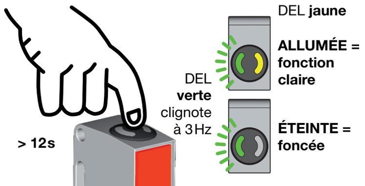
**Verrouillage de la touche d'apprentissage par l'entrée d'apprentissage**
