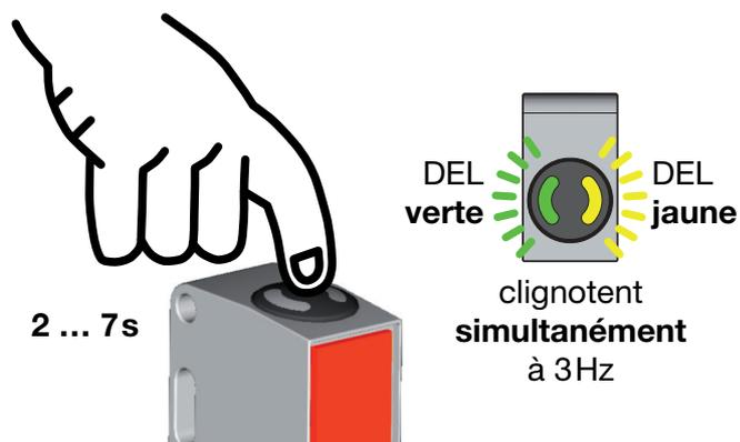
**Apprentissage pour une sensibilité du capteur de 18% (bouteilles standard)**
