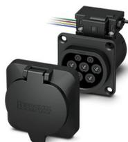
CHARX connect modular, Prise côté infrastructure, Rectangulaire, Basic, Kit, avec capot de protection carré, pour la charge en courant alternatif (AC) des véhicules électriques (VE), Type 2, CEI 62196-2, 32 A / 480 V (AC), sans fils individuels, actionneur de verrouillage: 12 V, 4 pôles, Montage sur la paroi arrière, Filetage M5, boîtiers: noir, Logo PHOENIX CONTACT
