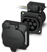
CHARX connect modular, Prise côté infrastructure, Rectangulaire, Basic, Kit, avec capot de protection carré, avec LED (raccord de cathode commun), pour la charge en courant alternatif (AC) des véhicules électriques (VE), Type 2, CEI 62196-2, 32 A / 480 V (AC), sans fils individuels, actionneur de verrouillage: 12 V, 4 pôles, Montage sur la paroi arrière, Filetage M5, boîtiers: noir, Logo PHOENIX CONTACT
