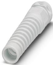
Presse-étoupe, matériau du raccordement vissé: PA, diamètre extérieur du câble 4,5 mm ... 10 mm, blindage: non, filetage de raccordement: M16 x 1,5, coloris: gris clair RAL 7035, avec protection anti-courbure
