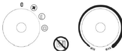
5. Une fois que la pièce atteint la température requise, l'élément chauffant arrête de fonctionner (témoin de chauffe s'éteint), mais le ventilateur continue de fonctionner. Quand la température a diminué, l'élément chauffant se remet à fonctionner. Le chauffage du ventilateur s'allume et s'arrête automatiquement et maintient ainsi la température ambiante constante.
