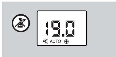
En cas d'absence prolongée, l'appareil diminue progressivement sa consigne de température. Lorsqu'il détecte une présence, il réagit et revient dans le mode de fonctionnement défini par l'utilisateur.
