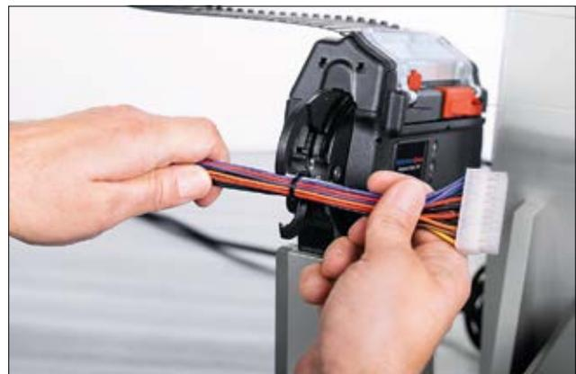
Application de frettage avec l'AT2000CPK installé sur le banc fixe.
