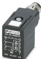
Connecteur pour électrovannes, 3-pôles, connecteur mâle coudé M12, détrompage: A, avec 1 LED, câblé avec Diode zéner, sur Connecteur de vanne BI (11 mm), avec 1 LED, câblé avec Diode zéner
