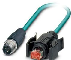
Câble de réseau, Ethernet CAT5 (100 Mbit/s), 4-pôles, connecteur mâle droit M12, sur connecteur mâle droit RJ45 Verrouillage à clip, longueur de câble: 2 m
