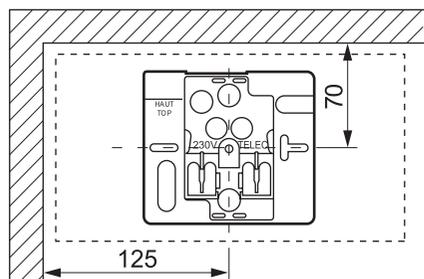
**TELEC :** Bornes de télécommande, il n'est pas nécessaire de respecter la polarité avec les télécommandes Legrand.
