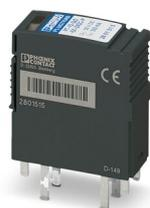
Fiche de protection antisurtension avec voyant de diagnostic et d'état à plusieurs niveaux intégré sur le module pour deux circuits de signaux Ex-i bifilaires indépendants du potentiel. Tension nominale : 24 V DC
