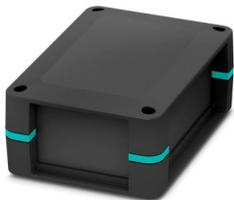
Boîtier complet pour circuit imprimé, fixé au niveau des inserts des montants d'angle, inclut des demi-coques de boîtier, des parois fermées, des inserts de montants d'angle avec support de fixation pour circuit imprimé, des vis pour boîtier et fixation du circuit imprimé, boîtier de couleur noire avec inserts de montants d'angle bleu turquoise
