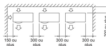
La hauteur de l'obstacle doit être inférieure à celle de l'unité extérieure.
