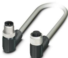
Câble préconfectionné pour bus, CANopen<sup>®</sup>, DeviceNet<sup>™</sup>, 5-pôles, blindé, connecteur mâle coudé M12, détrompage: A, sur Connecteur femelle coudé M12, détrompage: A, longueur de câble: 1,5 m, Connecteur non blindé
