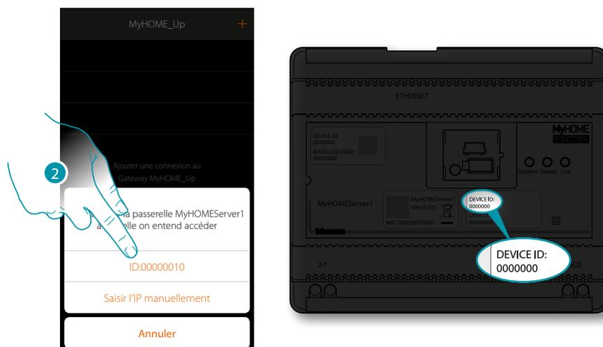
2. Sélectionner le MyHOMEServer1 en l'identifiant avec le DEVICE ID (ID dispositif) présent sur la partie frontale du dispositif.
