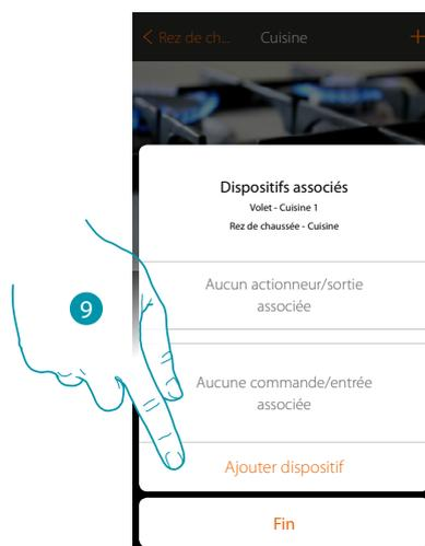
Pour associer l'objet graphique volet
