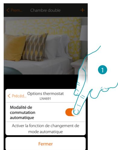
1. Sur les installations à ventilo-convecteurs à 4 tuyaux prévus pour le chauffage et pour la climatisation ou sur les installations dont les circuits de circulation d'eau pour le chauffage et pour la climatisation sont totalement indépendants, il est possible d'activer cette fonction pour gérer automatiquement la commutation entre chauffage et climatisation.
