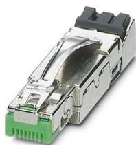
Connecteur RJ45, type: RJ45, indice de protection: IP20, nombre de pôles: 6, 100 Mbit/s, CAT5, matériau: Métal, type de raccordement: Raccordement autodénudant, section raccordable: AWG 26- 24, sortie du câble: droit, Haute résistance aux vibrations ; blindage 360° ; thème One-Piece ; fabrication ne nécessitant pas d'outils spéciaux, VARAN
