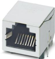
Connecteurs pour circuits imprimés RJ45, type: RJ45, indice de protection: IP20, nombre de pôles: 8, 10 Gbit/s, matériau: Métal, type de raccordement: Par refusion THR / à la vague THT
