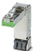
Connecteur RJ45, type: RJ45, indice de protection: IP20, nombre de pôles: 6, 100 Mbit/s, CAT5 (CEI 11801:2002), matériau: Métal, type de raccordement: Raccordement autodénudant, section raccordable: AWG 26- 24, sortie du câble: coudé, Haute résistance aux vibrations ; blindage 360° ; thème One-Piece ; fabrication ne nécessitant pas d'outils spéciaux, VARAN
