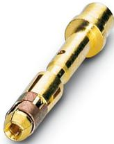
Contact à sertir, Connecteur femelle, tournés, diamètre de contact: 1,5 mm, zone de sertissage: 0,25 mm<sup>2</sup> ... 2,5 mm<sup>2</sup>, L'article est sans plomb, conformément à la directive RoHS II, sans exception 6c (Pb < 0,1 %)
