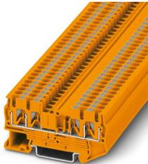
Blocs de jonction simple, tension nominale: 800 V, intensité nominale: 24 A, nombre de connexions: 4, type de raccordement: Raccordement Push-in, Section de référence: 2,5 mm<sup>2</sup>, section : 0,14 mm<sup>2</sup> - 4 mm<sup>2</sup>, type de montage: NS 35/7,5, NS 35/15, coloris: orange
