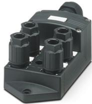
Boîtier répartiteur, type de raccordement: QUICKON, 0,14 mm<sup>2</sup> ... 0,75 mm<sup>2</sup>, nombre de prises: 4, nombre de pôles: 5, affectation des prises: double, affichage d'état: Oui, pnp; racc. câble multicond.: Raccordement Push-in 180°, blindage: non, Lors du raccordement de 5 conducteurs, possibilité de raccorder au maximum 0,5 mm<sup>2</sup>
