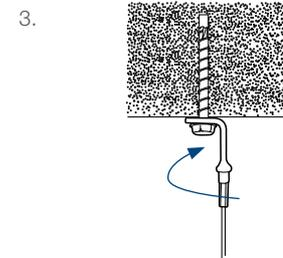
Étape 3 - installer la vis béton à l'aide d'une clé à choc avec un couple de serrage maximum de 150 Nm
