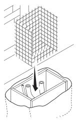
Insérer les vis fournies dans la plaque de fixation. Bloquer les vis à l'aide des écrous fournis. Extraire les agrafes préformées à l'aide d'un tournevis. Introduire la plaque de fixation dans la grille en fer.
