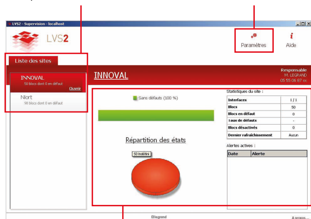
Résumé de l'état de votre installation par site, avec le nombre de défaut repéré ainsi que la répartition des états
