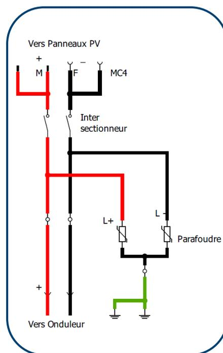
Figure 3 : Schéma de principe PV2-625 ref 10612111
