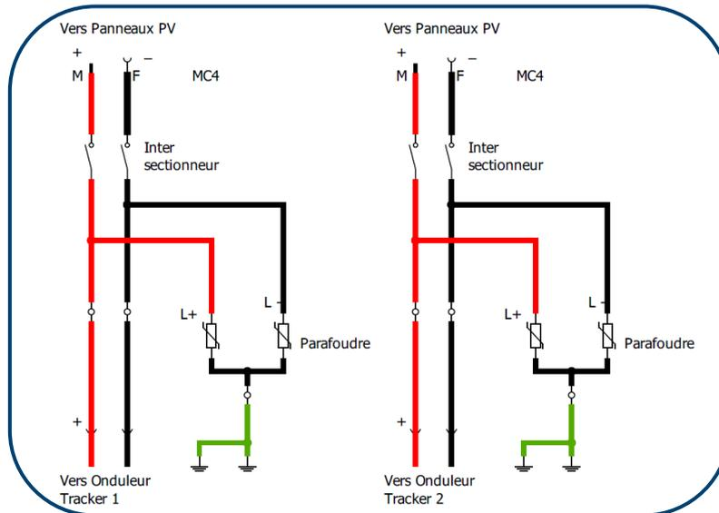
Figure 4 : Schéma de principe 2PV1-625 ref 10622111
