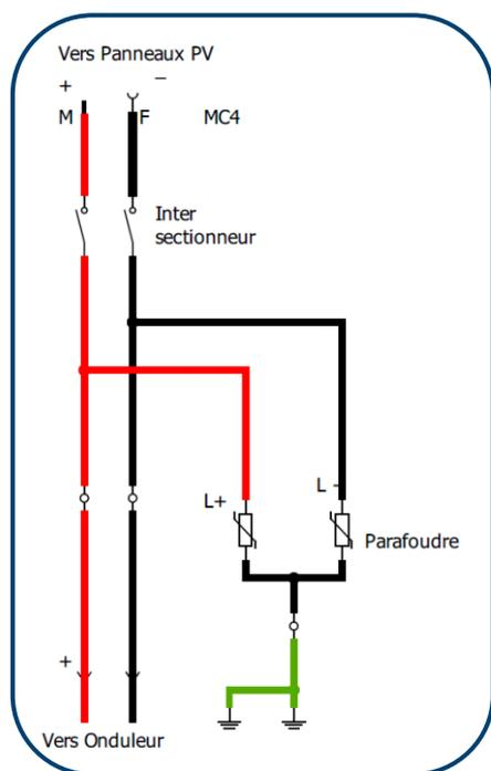
Figure 1 : Schéma de principe PV1-625 ref 10611111
