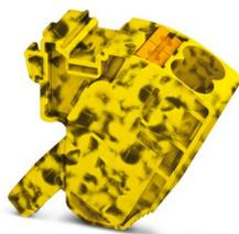
Bloc de jonction de dérivation, tension nominale: 1500 V, intensité nominale: 57 A, nombre de connexions: 2, type de raccordement: Raccordement Push-in, 1er étage, Section de référence: 10 mm<sup>2</sup>, section : 0,5 mm<sup>2</sup> - 16 mm<sup>2</sup>, type de montage: sur embase, coloris: noir/jaune
