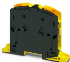
Bloc de jonction de puissance, tension nominale: 1000 V, intensité nominale: 232 A, nombre de connexions: 2, nombre de pôles: 1, type de raccordement: Raccordement PowerTurn, 1er étage, section : 25 mm<sup>2</sup> - 95 mm<sup>2</sup>, type de montage: vissage direct, coloris: noir/jaune
