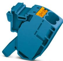
Bloc de jonction de dérivation, tension nominale: 1500 V, intensité nominale: 57 A, nombre de connexions: 2, type de raccordement: Raccordement Push-in, 1er étage, Section de référence: 10 mm<sup>2</sup>, section : 0,5 mm<sup>2</sup> - 16 mm<sup>2</sup>, type de montage: sur embase, coloris: bleu
