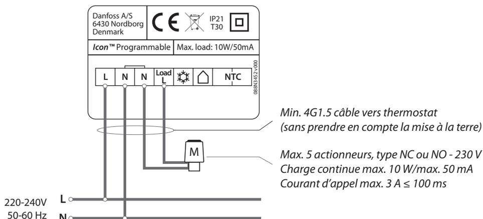
**Câblage avec boîtier de raccordement central**
