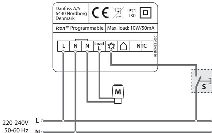
**S:** Il peut s'agir d'un commutateur mécanique été/hiver ou d'un relais activé par un dispositif externe.
