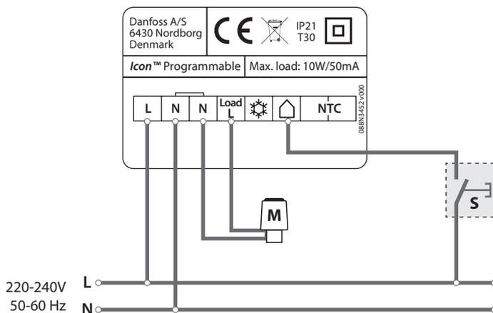
**S:** Il peut s'agir d'un commutateur mécanique Home/Away (présence/absence) ou d'un relais activé par un dispositif externe.
