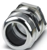
Presse-étoupe, matériau du raccordement vissé: Laiton, nickelé, diamètre extérieur du câble 27 mm ... 38 mm, blindage: non, filetage de raccordement: M50 x 1,5, coloris: argenté, avec joint torique
