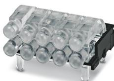
Fibre optique multiple à protection contre les surexpositions, passif, rigide, utilisable pour les familles de boîtiers ME, ME MAX, ME-IO, ME PLC et EH (traitement du boîtier nécessaire)
