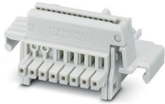
Connecteurs sur profilé, coloris: gris clair, intensité nominale: 6 A, 4 A (contacts parallèles) (Contacts série), tension de référence (III/2): 32 V, nombre de pôles: 8, pas: 2,54 mm, montage: Montage sur profilé, verrouillage: sans, type de fixation: sans, type de conditionnement: emballé dans un carton, Article avec contacts dorés, connecteur de bus pour le raccordement de boîtiers électroniques, 4 contacts parallèles/4 contacts série
