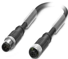
Câble pour capteurs/actionneurs, 4-pôles exempt d'halogène, blindé (Advanced Shielding Technology), connecteur mâle droit M12, détrompage: A, sur Connecteur femelle droit M12, détrompage: A, longueur de câble: 1,5 m
