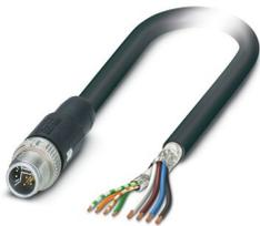
Câble hybride, Ethernet hybride CAT5 (100 Mbit/s), 8-pôles, Type de câble variable, blindé, connecteur mâle droit M12, détrompage: Y SPEEDCONNEC / IP67, sur extrémité libre, longueur de câble: Longueur au choix (0,2... 40,0 m), Power with Ethernet (PWE)
