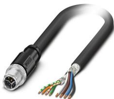
Câble hybride, Ethernet hybride CAT5 (100 Mbit/s), 8-pôles exempt d'halogène, blindé (Advanced Shielding Technology), connecteur mâle droit M12, détrompage: Y / IP65/IP67, sur extrémité libre, longueur de câble: 10 m, Power with Ethernet (PWE)
