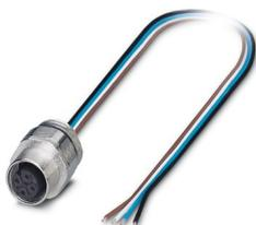
Embases paroi avant, Universel, 4-pôles, connecteur femelle, droit, M12-Standard, détrompage: A, sur extrémité libre, Montage sur face avant, Pg9, Cordons individuels, longueur de câble: 0,5 m, 0,34 mm<sup>2</sup>, Cordon TPE, Produit de remplacement selon RoHS II sans exception 6c (Pb < 0,1 %) référence : 1245653
