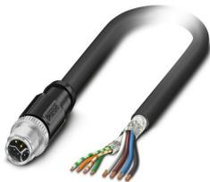
Câble hybride, Ethernet hybride CAT5 (100 Mbit/s), 8-pôles exempt d'halogène, blindé (Advanced Shielding Technology), connecteur mâle droit M12, détrompage: Y / IP65/IP67, sur extrémité libre, longueur de câble: 5 m, Power with Ethernet (PWE)
