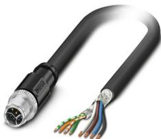
Câble hybride, Ethernet hybride CAT5 (100 Mbit/s), 8-pôles exempt d'halogène, blindé (Advanced Shielding Technology), connecteur mâle droit M12, détrompage: Y / IP65/IP67, sur extrémité libre, longueur de câble: 2 m, Power with Ethernet (PWE)
