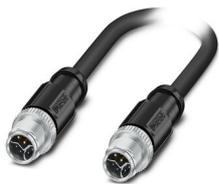
Câble hybride, Ethernet hybride CAT5 (100 Mbit/s), 8-pôles exempt d'halogène, blindé (Advanced Shielding Technology), connecteur mâle droit M12, détrompage: Y / IP65/IP67, sur connecteur mâle droit M12, détrompage: Y / IP65/IP67, longueur de câble: 5 m, Power with Ethernet (PWE)
