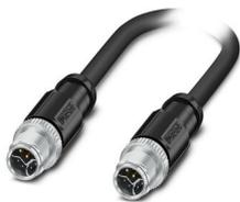
Câble hybride, Ethernet hybride CAT5 (100 Mbit/s), 8-pôles exempt d'halogène, blindé (Advanced Shielding Technology), connecteur mâle droit M12, détrompage: Y / IP65/IP67, sur connecteur mâle droit M12, détrompage: Y / IP65/IP67, longueur de câble: 1 m, Power with Ethernet (PWE)
