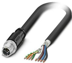
Câble hybride, Ethernet hybride CAT5 (100 Mbit/s), 8-pôles exempt d'halogène, blindé (Advanced Shielding Technology), connecteur mâle droit M12, détrompage: Y / IP65/IP67, sur extrémité libre, longueur de câble: 1 m, Power with Ethernet (PWE)
