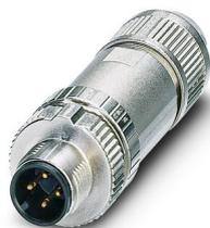
Connecteur, Universel, 4-pôles, blindé, connecteur mâle droit M12, A, Raccordement à ressort Push-Lock, matériau de la molette: Zinc moulé sous pression, nickelé, diamètre extérieur du câble 4 mm ... 8 mm
