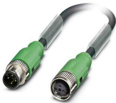
Câble pour capteurs/actionneurs, 4-pôles, Type de câble variable, blindé, connecteur mâle droit M12, détrompage: A SPEEDCONNEC, sur Connecteur femelle droit M12, détrompage: A SPEEDCONNEC, longueur de câble: Longueur au choix (0,2... 40,0 m)
