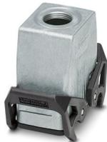
Boîtier prolongateur B10, avec étrier transversal, matériau: Aluminium coulé sous pression, résistant à l'eau de mer, nombre de sorties: 1, droit, 1x Pg21, hauteur: 73 mm, presse-étoupe: sans, Standard
