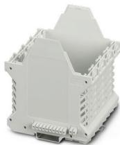
Boîtier électronique sur rail DIN, Partie inférieure du boîtier avec pied métallique de verrouillage, 4 contacts FE, design élancé, avec fentes d'aération, largeur: 90,4 mm, hauteur: 99 mm, profondeur: 107,3 mm, coloris: gris clair (7035), connexion transversale: connecteur de bus intégré, nombre de pôles connecteur transversal: 10+2, Connecteur de bus : 10 contacts parallèles, 2 contacts série
