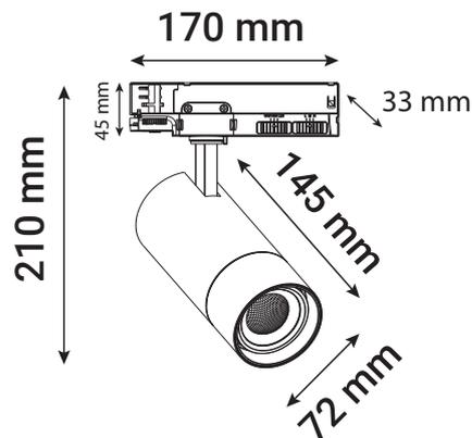
**Pour régler l'angle :** Faites tourner la bague indiquant les angles à l'avant du produit.
