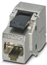
Isolant femelle RJ45, modulaire (Keystone), CAT6, 8 pôles, blindé, avec raccordement de câble (LSA), pour cordons et fils rigides AWG 26 ... 22
