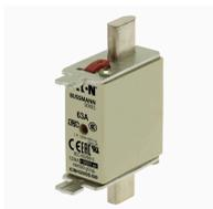
**Cartouche fusible, Basse tension, 63 A, AC 690 V, 120 kA, NH000, gL/gG, IEC, système d'indicateur de fusion double (combinaison), pattes d'extraction conductrices**
